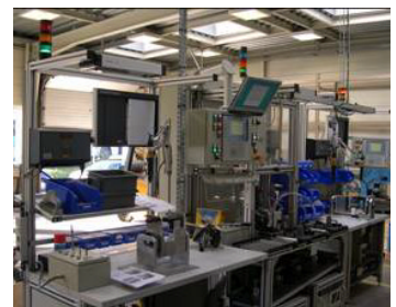
Linea de ensamblaje manual de bombas
