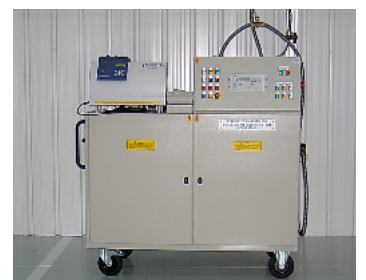
Baie de contrôle étanchéité
